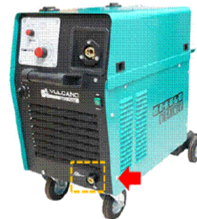
Projeto de máquina com as conexões de encaixe contra fuga e protegida
